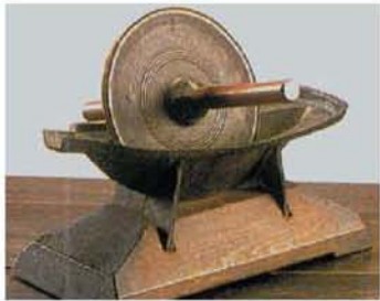
薬研(やげん) 舟形の台座の中で円盤を前後させて、生薬を押し砕く道具。
