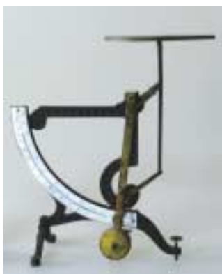
▲ (左より) 振り子式自動指示秤 37×24×17 1900年前後のものと思われる。台の上に物を載せると、台が下がり、下の振り子が目盛を指す仕組みの秤。
