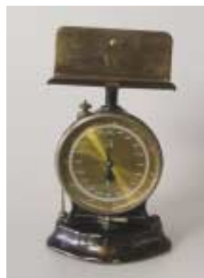
▲ (左より) 振り子式自動指示秤 37×24×17 1900年前後のものと思われる。台の上に物を載せると、台が下がり、下の振り子が目盛を指す仕組みの秤。
